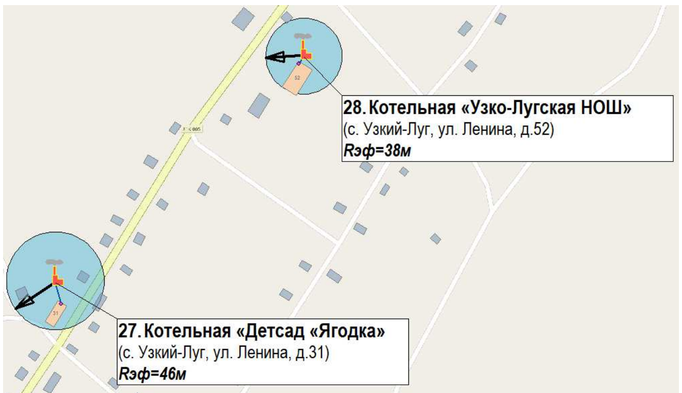
Рис. 2.81. Схема существующих радиусов эффективного теплоснабжения от котельной «Детсад «Ягодка» и котельной «Узко-Лугская НОШ»
