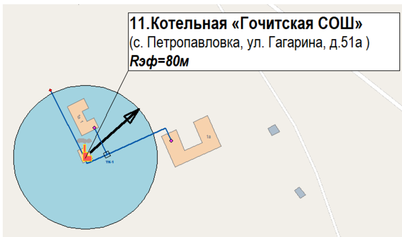
Рис. 2.67. Схема существующего радиуса эффективного теплоснабжения от котельной «Гочитская СОШ»
