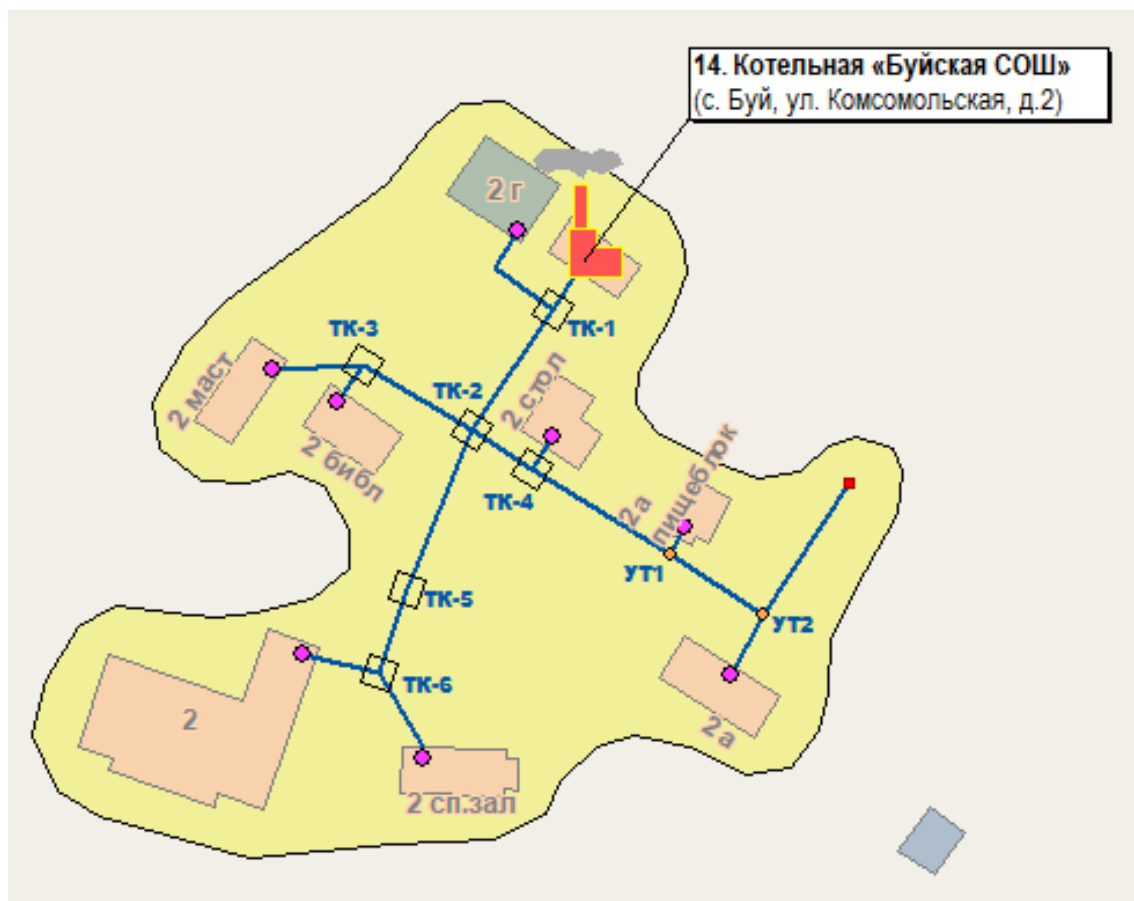
Рис. 2.14. Существующая зона действия системы теплоснабжения и централизованного источника тепловой энергии – котельной «Буйская СОШ»
