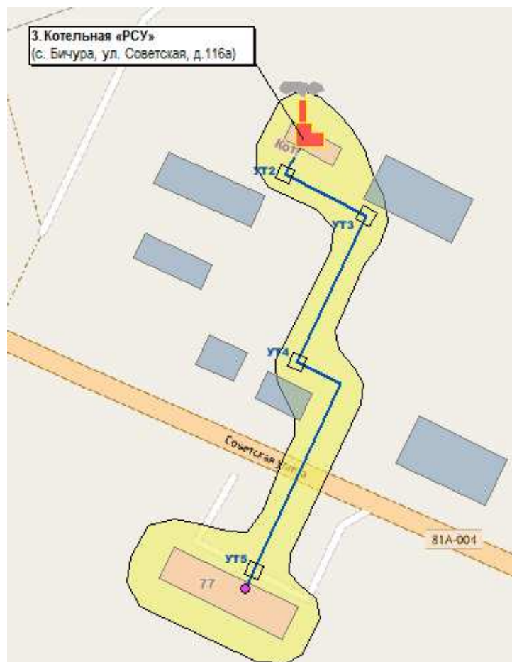
Рис. 2.3. Существующая зона действия системы теплоснабжения и централизованного источника тепловой энергии – котельной «PCУ»
