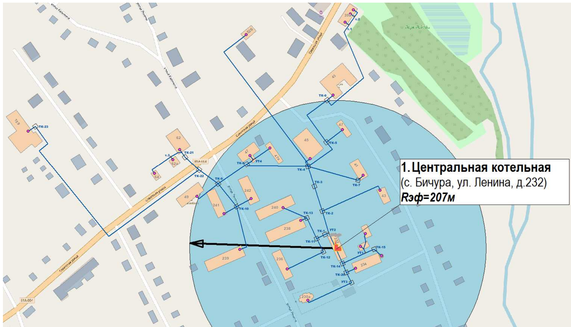
Рис. 2.57. Схема существующего радиуса эффективного теплоснабжения от Центральной котельной
