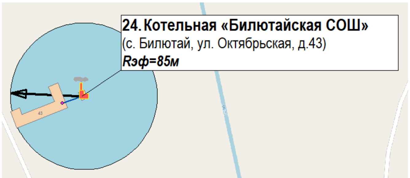
Рис. 2.80. Схема существующего радиуса эффективного теплоснабжения от котельной «Билютайская СОШ»
