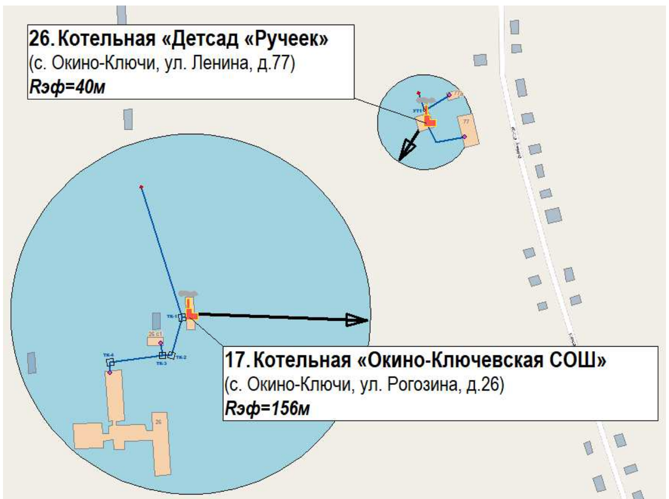
Рис. 2.73. Схема существующих радиусов эффективного теплоснабжения от котельной «Окино-Ключевская СОШ» и котельной «Детсад «Ручеек»
